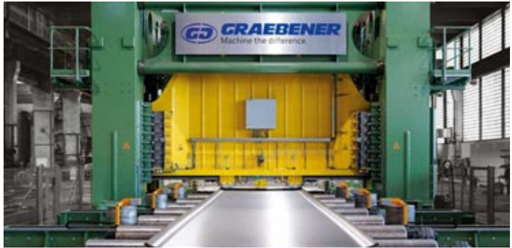
Im Bild die Gräbener 2-Seiten-Anbiegepresse.
