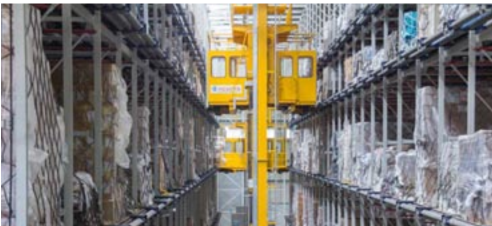
Beispielbild: ETV im Hochregallager eines Luftfrachtterminals.
