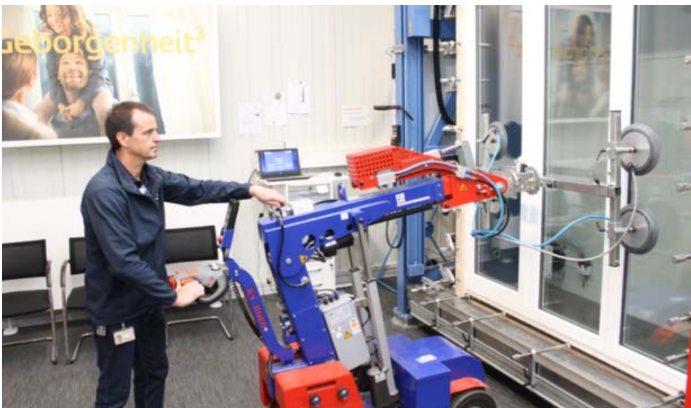
Florian Augustin ist schwerbehindert und darf keine schweren Lasten heben. Deshalb hat das Unternehmen eine Hebehilfe angeschafft, mit der auch schwere Türen und Fenster auf die Prüfstände gebracht werden können.
